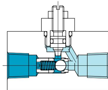
●絞り弁と逆止め弁を組み合わせた機能を持ち、一方向の流量を制御し、逆方向は自由流れとなります。
