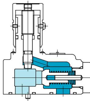
●最高使用圧力31.5 MPaまでの油圧回路に使用できます。
