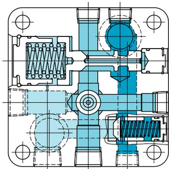
●圧力・温度補償機構付きのため、負荷圧力および作動油温度が変化しても、流量は一定に保たれます。また逆方向には自由流れとなります。
